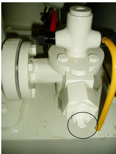
附图 3. 安全阀调整装置（图中画圆圈处）（左边为常规压力，右边为高油压）
