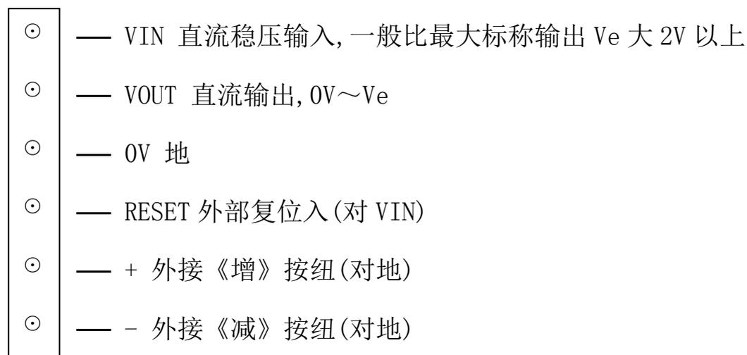
注： $V_{IN}$  直流稳压输入可以用三端稳压器 78 $\times\times$  或用稳压二极管稳压得到。RESET 外部复位可以用合闸开关的常闭触点（最好经小型中间继电器）连接到  $V_{IN}$  直流电压上，内部有微分电路会自动转换成窄复位脉冲。
